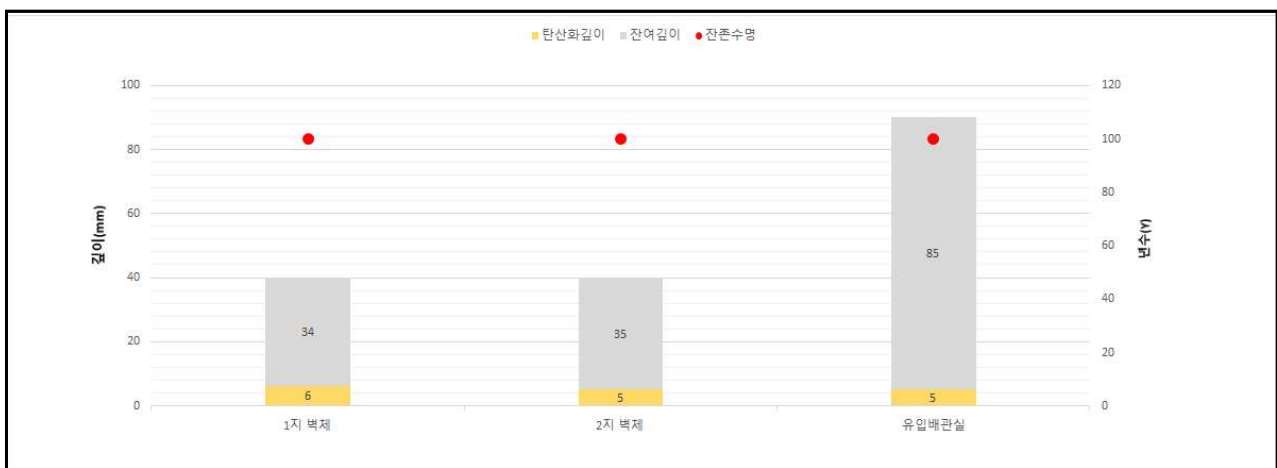
【그림 1.2】 탄산화시험 측정결과 그래프
